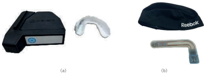
図6 頭部衝撃を測定するウェアラブルセンサの例：(a) マウスガード内蔵型(Prevent Biometrics社製)、(b) スカルキャップ内蔵型(Reebok社製)。
